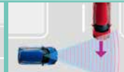
■交差点衝突回避支援(出合頭車向)
